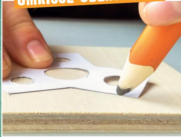
Nun brauchst Du einen Bleistift, die Schablone und ein 10 x 10 cm großes Holzstück, 6 mm dick. Übertrage mithilfe der Schablone den Umriss des Spinners und der vier Löcher auf das Holzstück. Arbeite genau, damit sich der Spinner später gleichmäßig dreht.
