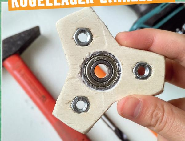
Nimm das Kugellager aus dem Tauchbad, reibe es gut mit den Papiertüchern ab – es muss ganz trocken sein, bevor Du es in Deinen Spinner einbaust. Streiche mit dem Pinsel ein bisschen Kleber an die Innenfläche des großen Lochs im Holz. Setze nun das Kugellager mit etwas Kraft in das Loch. Wische den überschüssigen Kleber mit einem Papiertuch ab und lass den Kleber trocknen. Fertig!
