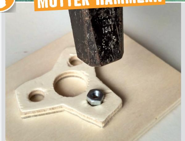
Setze eine der drei Sechskant-Muttern gerade auf das erste Loch und schlage sie mit dem Hammer vorsichtig und gleichmäßig ein.
