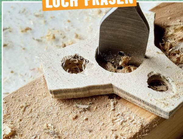
Fräse danach mit einem 22-mm-Fräser ein großes Loch für das Kugellager genau in der Mitte. Wenn die Löcher gebohrt sind, sieht der Fingerkreisel schon fast fertig aus.
