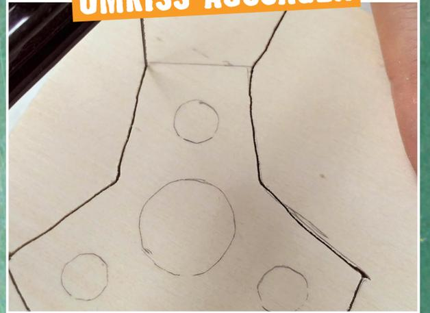
Spanne Dein Holzstück dann ganz fest mit einer Zwinde an den Tisch. Säge mit einer Laubsäge vorsichtig am aufgemalten Umriss entlang – dafür musst Du die Zwinde zwischendurch lösen, Dein Holzstück drehen und erneut festspannen.
