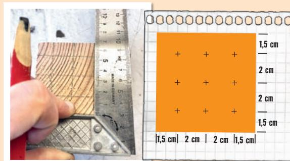
**02** Spanne den Würfel in einen Schraubstock. Bohre mit dem Akkubohrer 9 Löcher mit dem 10 mm Holzbohrer senkrecht in den Holzblock.
