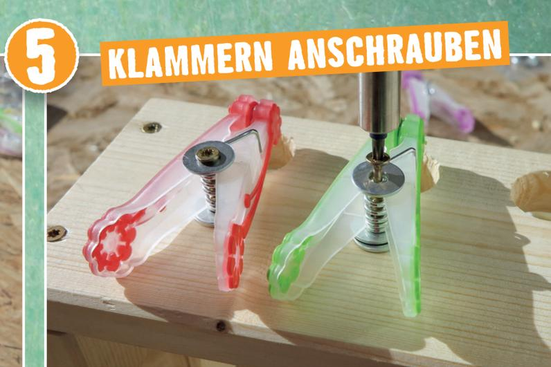
Jetzt werden vier Wäscheklammern auf das Toolboard geschraubt. Mit ihnen kannst Du später Dein Werkzeug fest in der Halterung einklemmen. Pro Klammer brauchst Du eine Schraube und drei Unterlegscheiben. Fädle eine Scheibe auf die Schraube. Führe die Schraube durch die Feder der Wäscheklammer. Vor dem Schrauben noch zwei Unterlegscheiben darunter. Mache es mit den drei übrigen Klammern genau so. Fertig!
