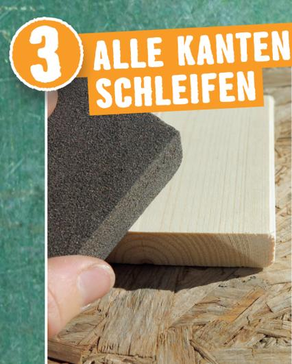
Schleife alle Kanten der beiden Füße mit Sandpapier ab, bis sich alles ganz glatt anfühlt. Nun werden die beiden Füße unter das lange Brett geschraubt. Setze dazu beide Füße unter das lange Brett mit den Löchern. Spanne eine Seite am Arbeitstisch mit Schraubzwingen fest. Bohre zwei Löcher durch das lange Brett genau mittig in den Fuß. Verschraube das Brett mit diesem Fuß. Und wiederhole dies für den zweiten Fuß.
