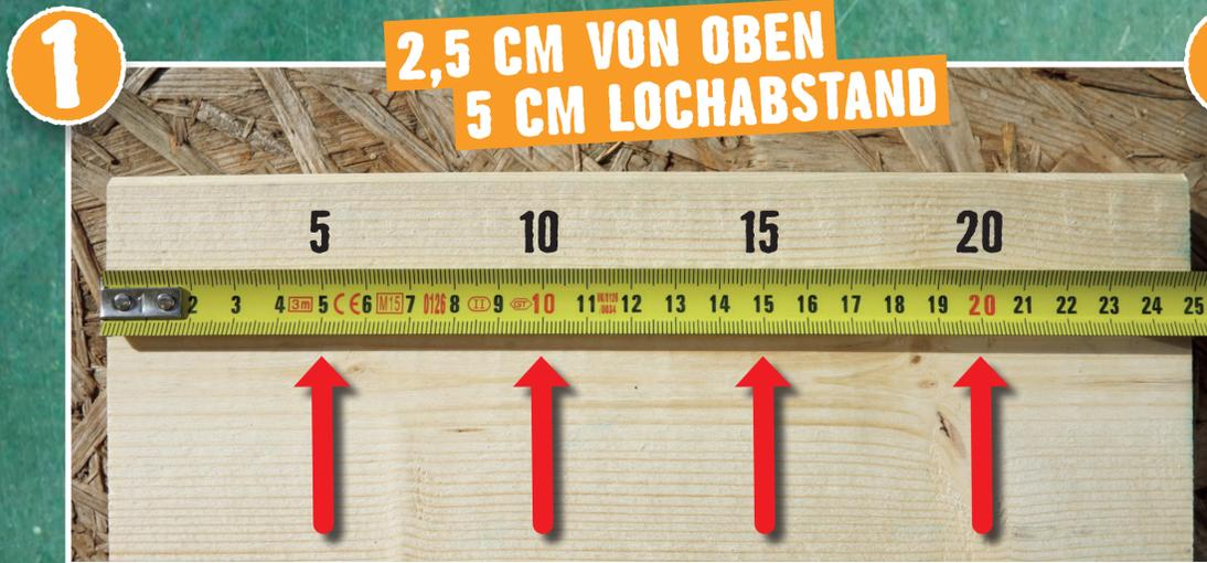
Für Dein Toolboard benötigst Du ein 25 cm langes Brett und zwei kürzere Stücke, die als Füße angeschraubt werden. Zuerst werden auf dem langen Brettstück die Abstände der Löcher abgemessen.
