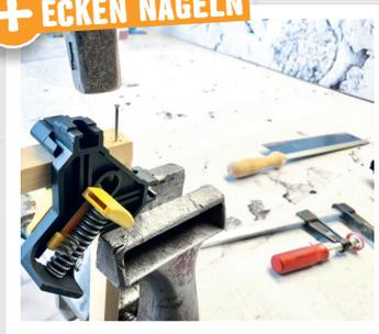
Verbinde als erstes zwei Ecken auf die gleiche Weise. Dabei sollte eine kurze Latte an eine lange Latte anschließen.
