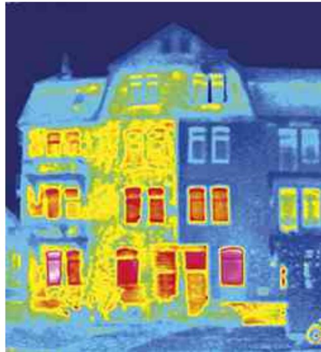
Der extreme Wärmeverlust eines alten Fensters wird durch das Infrarotbild deutlich.
