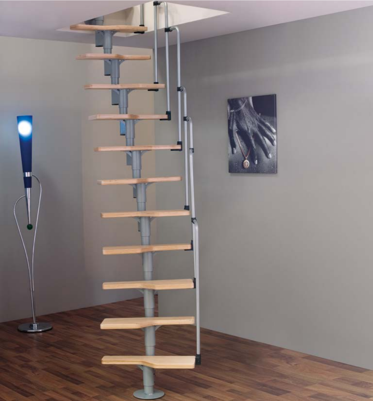
EOS Stufen aus Birke, Multiplex, lackiert Holm und Geländer mit Silberfarbe Pulverbeschichtet
