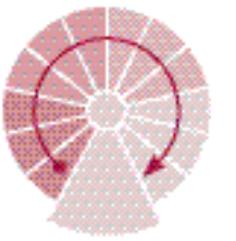
Rechtsgewendelt: von unten nach oben im Uhr- zeigersinn, die Mittelsäule ist rechter Hand
