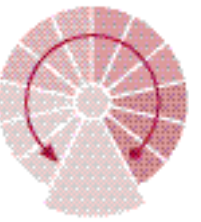
Linksgewendelt: von unten nach oben gegen den Uhrzeigersinn, die Mittelsäule ist linker Hand
