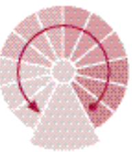
Linksgewendelt: von unten nach oben gegen den Uhrzeigersinn, die Mittelsäule ist linker Hand
