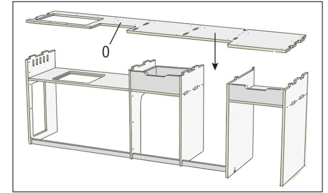
Lege die Korpusabdeckung (O) auf den Schrank auf und stecke die Abdeckung in die Zapfen der Schrankwände ein. Sie wird durch die vorgesehenen Schraubenlöcher von oben und zusätzlich durch die Seitenwände verschraubt. Die Verschraubungen erfolgen mit Senkkopfschrauben 3,5x35 mm.
