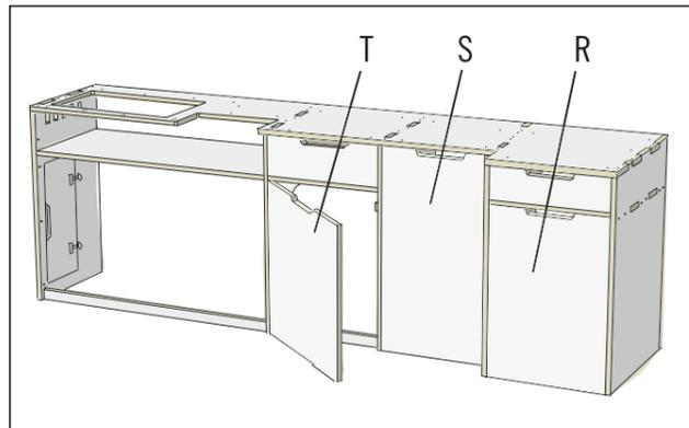
Nach dem Montieren müssen die Türen vorne am Korpus bündig abschließen.
