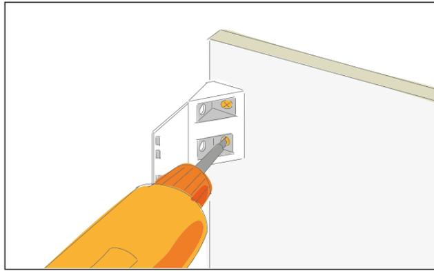
Damit die Frontplatte befestigt werden kann, muss auf jeder Seite ein Universal-Eckverbinder angeschraubt werden. Die Eckverbinder sitzen dabei vorne bündig an der Kante der Seitenwand. Schraube sie mit Senkkopfschrauben 3x16 mm an. Die Schraubenlöcher müssen nicht vorgebohrt werden.
