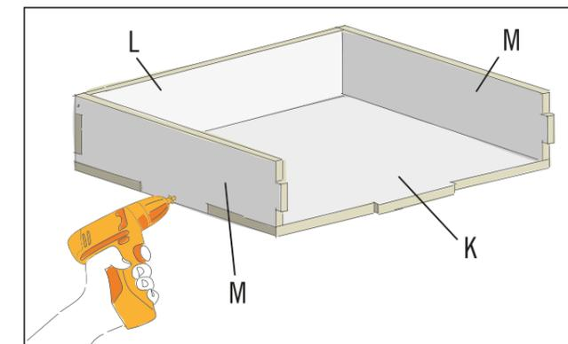
Verschraube die Seitenwände (M) und die Rückwand (L) an der Grundplatte (K). Die Verschraubungen erfolgen von der Seite in die Grundplatte und dann durch die Grundplatte in die Wände. Es werden Senkkopfschrauben 3,5x35 mm verwendet.
