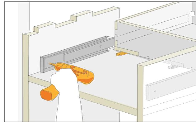
Setze die Schublade in die Schranköffnungen ein und unterlege sie mit 2 mm dicken Keilen. Verschraube die Schubladenschienen am hinteren, dicken Teil an den Seitenwänden der jeweiligen Schranköffnung. Verwende Senkkopfschrauben 4x16 mm. Achte darauf, dass die Schienen parallel zur Schranköffnung montiert werden und sich die Schublade leichtgängig verschieben lässt.
