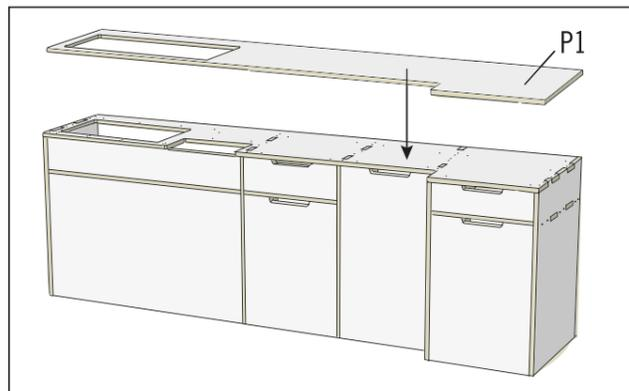
Lege die Arbeitsplatte (P1) deckungsgleich auf die Korpusabdeckung (O) auf und verschraube sie von unten mit Senkkopfschrauben 3x25 mm.
