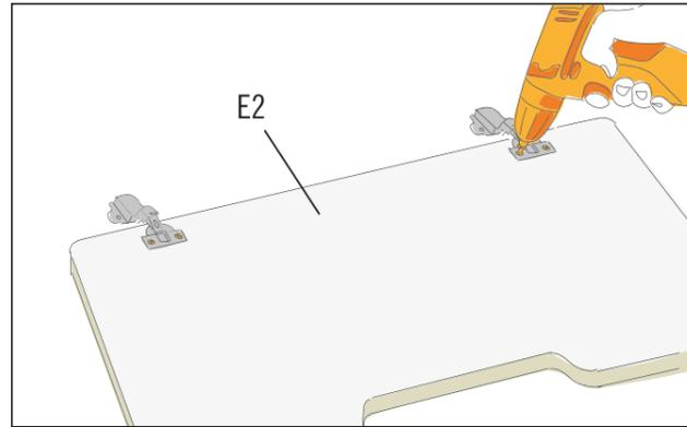
Montiere die beiden Topfscharniere an der Tür (E2). Verwende dazu Senkkopfschrauben 3x16 mm.
