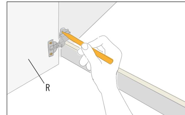
Bereite die Befestigungslöcher für die Türen am Schrankkorpus vor. Montiere dazu die Topfscharniere an den Türen (R), (S) und (T). Verwende dazu Senkkopfschrauben 3x16 mm. Platziere die Türen mit einem Helfer jeweils an den Montagestellen und markiere die Schraubenpositionen durch die Montageplatten der Scharniere.
