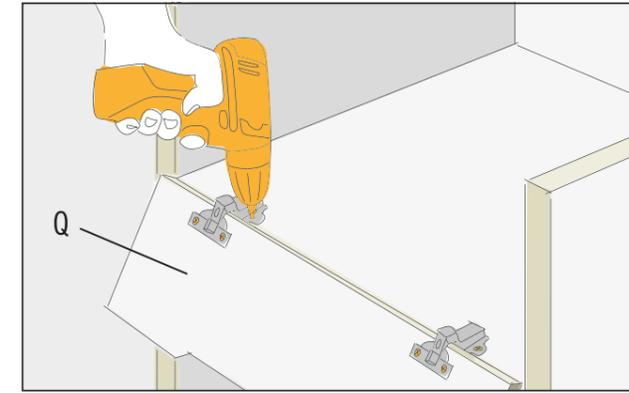
Montiere die Topfscharniere an der Klapptür (Q) mit Senkkopfschrauben 3x16 mm. Markiere die Schraubenpositionen durch die Montageplatten der Scharniere am Korpus und bohre sie vor. Dann die Topfscharniere anschrauben.
