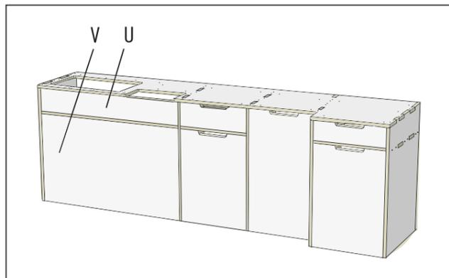
Die beiden Abdeckplatten (U) und (V) werden nach dem Einsetzen durch die Seitenwand (E) und die Zwischenwand (D) verschraubt. Verwende Senkkopfschrauben 3,5x35 mm. Die Schraubenlöcher sind vorgebohrt.
