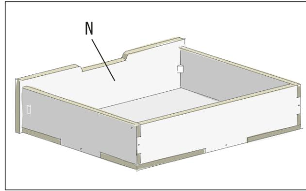
Danach kann die Frontplatte (N) an den Zapfen der Seitenwände und der Grundplatte aufgesteckt und an den Eckverbindern angeschraubt werden.
