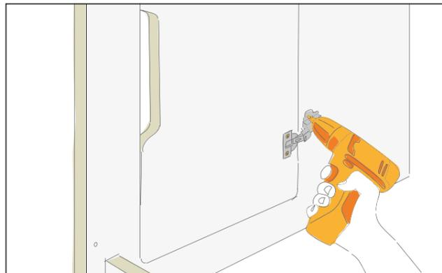
Platziere die Tür mit einem Helfer in der Türöffnung (E1) und markiere die Schraubenpositionen durch die Montageplatten der Scharniere. Bohre die Schraubenlöcher an den Markierungen vor und verschraube dann die Scharniere am Korpus mit Senkkopfschrauben 3x16 mm.
