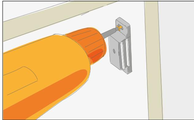
Als Anschlag für die Türen werden Magnetschnäpper montiert. Die beiliegenden Metallplättchen werden an den Türen so angebracht, dass diese an den Magneten festgehalten werden.
