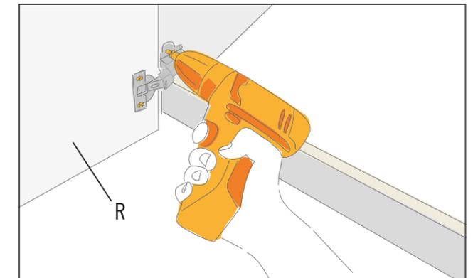
Bohre die Schraubenlöcher an den Markierungen vor und verschraube dann die Scharniere am Korpus mit Senkkopfschrauben 3x16 mm.
