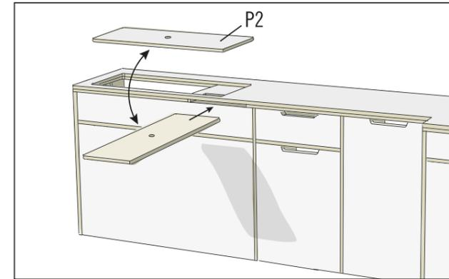
Die Abdeckplatte (P2) kann abgenommen und in den Schlitz an der Vorderkante eingeschoben werden. Die Platte kann dann herausgezogen und als Tisch verwendet werden.
