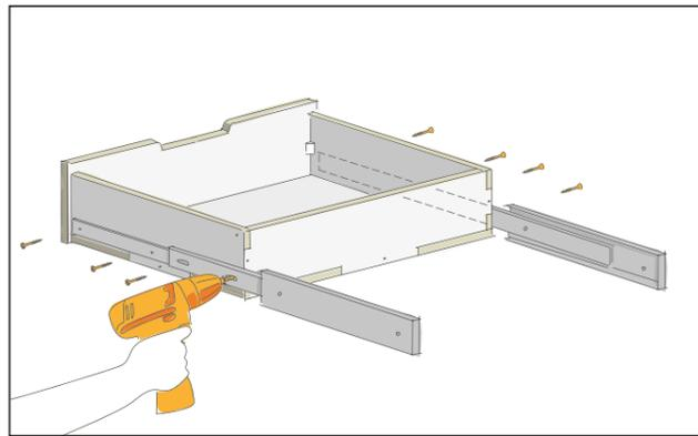
An der Schublade werden jeweils zwei Schubladenschienen angebracht. Ziehe die Schienen komplett auseinander und verschraube sie mit Senkkopfschrauben 4x16 mm durch den mittleren Teil des Auszuges direkt über der Bodenplatte der Schublade. Dann am vorderen Auszug ebenfalls an der Schublade verschrauben. Achte darauf, dass die Schienen parallel zur Schublade montiert werden.
