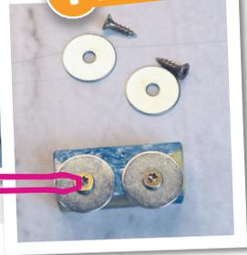
An die Lok und an die zwei Waggons kommen jeweils 4 Unterlegscheiben als Räder. Lege immer zwei auf einer Seite auf und zeichne die Bohrlöcher an. Achte darauf, dass alle Räder auf der gleichen Höhe angebracht sind. Bohre mit einem 3 mm Holzbohrer vor. Schraube die Räder mit kleinen Schrauben fest. Teste jetzt ob die Räder rollen. Wenn nicht musst Du die Schrauben etwas lösen.
