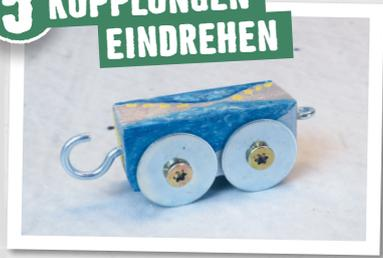
Markiere die Löcher für die Kupplungen: An den Waggons auf beiden Seiten mittig und bei der Lok hinten auf gleicher Höhe. Bohre die Löcher mit dem 3 mm Bohrer ein wenig vor. Die Lok zieht alle Waggons an einer Ringschraube, die Waggons bekommen je eine Ringschraube und einen Haken.
