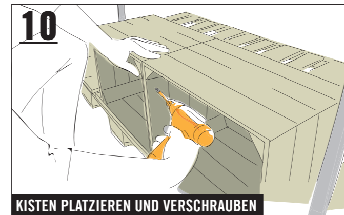
Die übrigen zwei Kisten (VARIANTE B: drei Kisten) auf der Palette platzieren und wieder mit jeweils vier Schrauben (4,5x25 mm) auf der Palette sowie mit vier Schrauben (4,5x20 mm) an der benachbarten Kiste fixieren.
