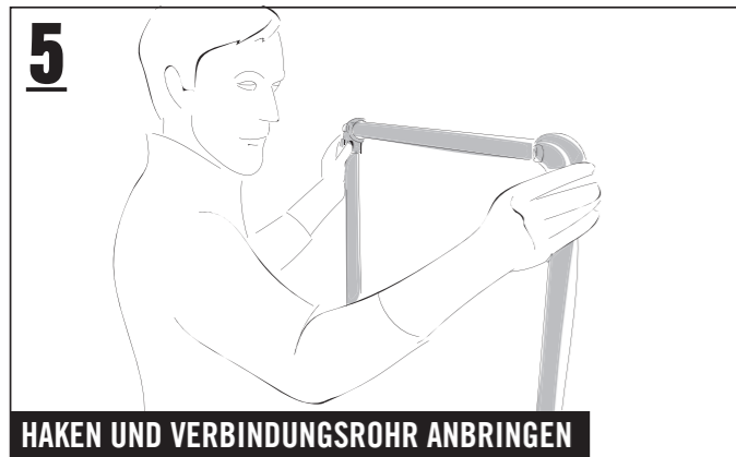
Die Haken auf die Stützrohre stülpen und das auf 960 mm gekürzte Verbindungsrohr mit jeweils einem Winkelstück an den Stützrohren (1430 mm) anbringen und mit einem Stiftschlüssel fixieren.
