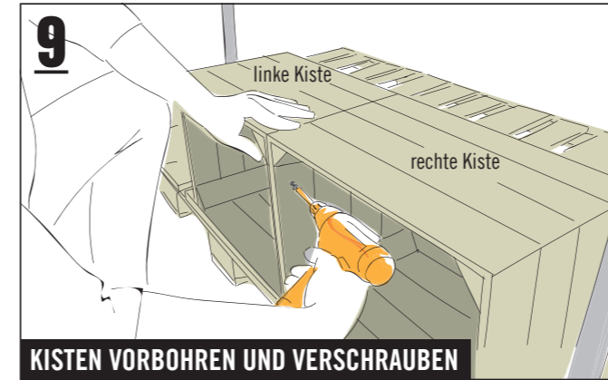
Im Inneren der Kisten acht Löcher mit dem „Bohrsenker“ vorbohren: vier Löcher, um die Kisten miteinander zu verbinden und jeweils vier Löcher, um die Kisten an der Palette zu befestigen. Anschließend mit Schrauben fixieren (siehe Bilder 9.1 und 9.2).
