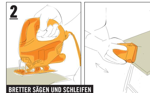
Das Brett (30x195x2500 mm) mit der Stichsäge zuschneiden auf 2 Stücke à 400 mm und 1 Stück à 300 mm. Schleifpapier um den Handschleifklotz wickeln und alle Schnittkanten schleifen, um Verletzungen zu vermeiden.
