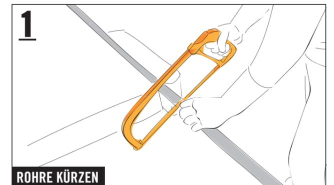
Trage für die folgenden Arbeitsschritte geeignete Schutzhandschuhe. Vier Rohre mit der Metallsäge auf 700 mm kürzen und aus den drei übrigen Rohren acht Stücke mit je 300 mm zuschneiden. Die Enden der abgesägten Rohre innen und außen mit der Halbrundfeile entgraten, um Verletzungen zu vermeiden.
