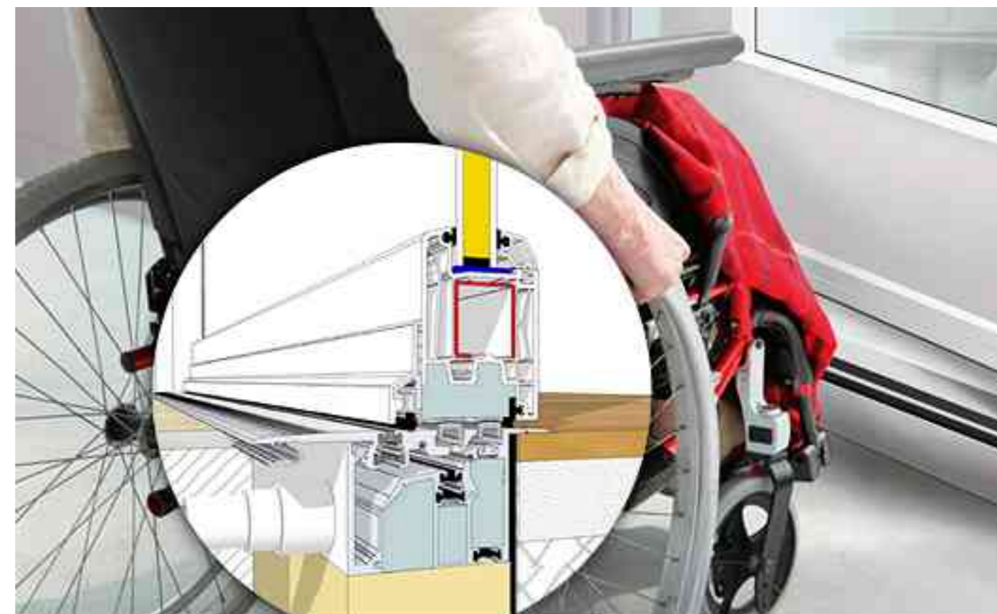
Barrierefreie Bodenschiene für Neubau inklusive Entwässerungsunterbau
