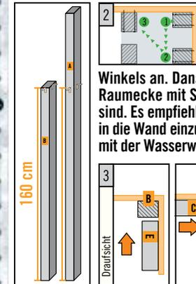
Alle Teile nach dem Maßplan zuschneiden. An allen Pfosten **A** u. **B** werden in einer Höhe von 160 cm jeweils 2 Winkel befestigt. Die 160 cm geben dabei die Oberkante des Winkels an. Danach wird zuerst der kurze Pfosten **B** in einer Raumecke mit Schrauben befestigt, die für die Wand geeignet sind. Es empfiehlt sich, die Schrauben direkt durch den Pfosten in die Wand einzulassen. Richte den Pfosten wie in Bild 2 gezeigt mit der Wasserwaage senkrecht aus, bevor Du ihn festschraubst.
