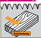
Die Zähne zeigen exakt gerade nach unten und haben messerähnliche Spitzen, weil sie zum rechtwinkligen Schnitt gegen die Holzfaser bestimmt sind. Dieser Sägentyp arbeitet in beiden Richtungen, hat jedoch auf Stoß seine beste Schnittleistung. Bügelsägen mit feinem Schnittbild haben diese Zahnung.
