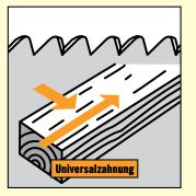
Zahnungen dieses Typs eignen sich hervorragend zum Sägen längs und quer zur Faserrichtung. Damit ermöglichen sie dem Heimwerker ein universelles Arbeiten. Die Zähne schneiden auf Stoß "aggressiver". Diese Zahnung ist bei allen normalen Handsägen üblich.
