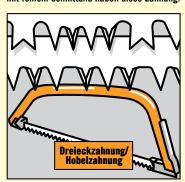
Ein spezieller Sägetyp zum Sägen trockenen und frischen Holzes mit austauschbaren dünnen und schmalen Blättern (dreieckoder hobelgezahnt) zur Verringerung der Reibung. Aber auch harte Hölzer lassen sich mit dieser Sägenart genauso gut sägen wie extrem dicke Hölzer.
