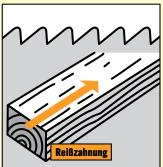
Mit einer solchen Säge arbeitet man in Faserrichtung; hauptsächlich einsetzbar zum Spalten von Brettern und Sägen von Ausklinkungen. Die Zähne arbeiten nur auf Stoß. Sie ist ebenso geeignet für unstrukturierte Verbundwerkstoffe wie z.B. Span- oder Faserplatten.
