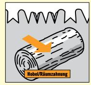
Hierbei handelt es sich um eine spezielle Art der Dreieckzahnung zum Sägen von nassem Holz mit grobem Schnitt. Dreieckzahngruppen wechseln sich hierbei mit kürzeren Räumzähnen ab. Die Zahnform ermöglicht das Entfernen des Sägemehls aus der Schnittfuge.
