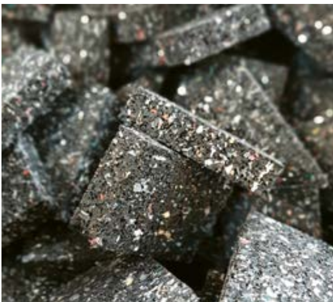
Isopads aus 95 % Altreifengranulat
