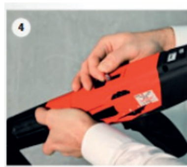
4 Bei der ersten Verwendung des Kartuschenstreifens muss die Ziffer 1 lesbar sein.
