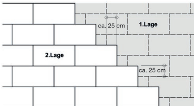
Abb. 21: Zweilagige Verlegung der Dämmplatten
