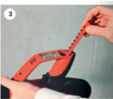
3 Anschließend wird der Kartuschenstreifen 6.8/11 M10 mit schmalen Ende voran von unten in den Griff des Gerätes eingeführt.
