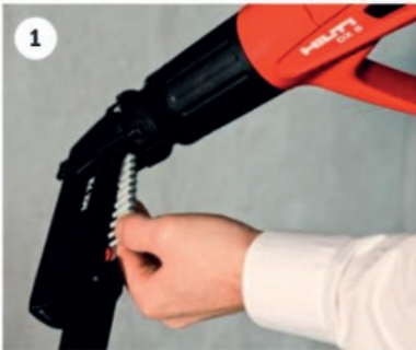
1 Das Nagelmagazin des Bolzensetzgerätes wird mit den X-X1 32 MX Nagelstreifen beladen
