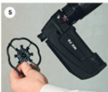
5 Der KlebeAnker X1 wird auf das Bolzensetzgerätaufgesteckt. Durch die spezielle Geometrie hält dieser selbstständig.
