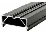
BIG-Isostep (Alu) 54 Terrassenlager Abstand Auflagepunkte max. 110 cm
