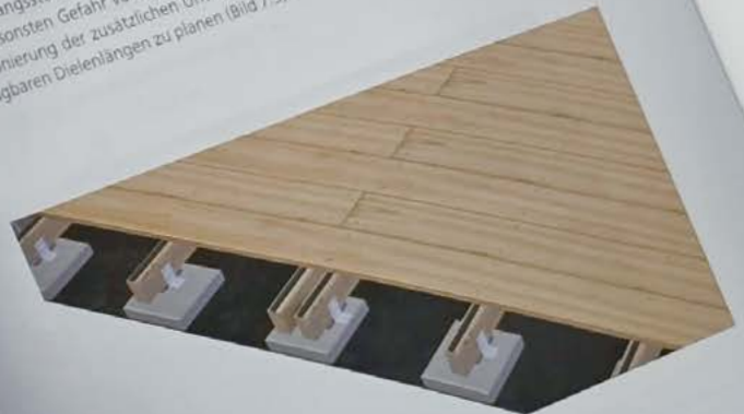
Bild 7.3 Ausführung von Längsstößen zwischen zwei Auflagern
