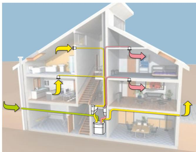
Aus Küche, Bad und WC wird Abluft abgesaugt und ihre Wärme wird über einen Wärmetauscher auf die Zuluft übertragen, die das Luftkanalsystem in Wohn- und Schlafräume transportiert.
