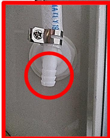
Bei der Montage der Düsen darauf achten, dass eine Düse auf einer Seite einen verschlossenen Zugang hat. Diese muss am Ende des Schlauchstranges positioniert sein.
