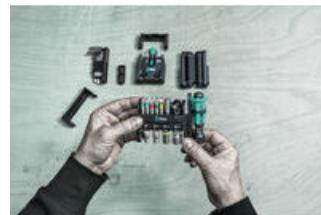
Tool-Check Modular: ermöglicht die individuelle Zusammenstellung unterschiedlichster Tool-Check Modular Elemente
