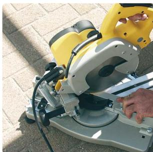
4) Anschließend wird das erste seitliche Befestigungsprofil vorbereitet. Schneiden Sie die Eckverbindungen auf Gehrung zu. Hierfür sollten Sie eine Kappsäge mit skaliertem, feststellbarem Schwenkbereich verwenden.
