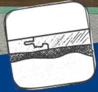
Punktuelle Unebenheiten im Estrich sind die nahezu unsichtbaren Zerstörer Ihres Laminat- und Parkettbodens. Schon minimale Unebenheiten ab 1 mm sorgen für eine Hohllage der Diele, welche zu einem Bruch der Klickverbindung führen kann.
