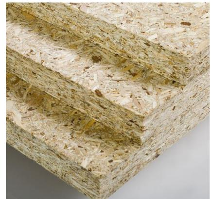
**MFP-Platten in 16 mm Stärke sind aufgrund ihrer hohen Festigkeit genauso belastbar wie 19 mm Massivholzelemente.**
