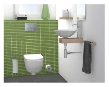
6) Um eine ausreichende Druckverteilung infolge der WC-Belastung sicher zu stellen, muss JACKOBOARD® Sabo verfliest werden. Die Verfliesung kann direkt auf JACKOBOARD® Sabo erfolgen. Prinzipiell können alle Fliesenarten und Fliesengrößen verwendet werden. Jedoch ist eine mind. Fliesengröße von 100 x 100 mm, und eine mind. Fliesendicke von 7 mm einzuhalten. Anschließend kann das WC auf den Fliesenbelag montiert werden.
