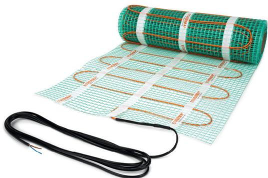
Die Netzheizmatte HOME MAX ist eine werkseitig konfektionierte Netzheizmatte zur Temperierung von Fußböden, zur Beheizung von Räumen oder zur Kälteabschottung an Wänden. Durch den nur 2,7 mm dünnen Aufbau ermöglicht die Netzheizmatte eine geringe Aufbauhöhe.
