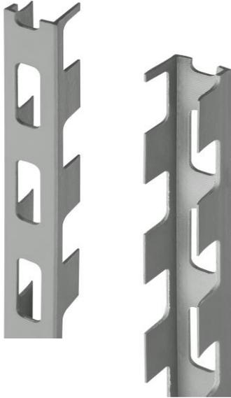
Drunterleisten aus PVC sind linienförmige Abstandhalter und werden beim Betonieren von Bodenplatten und Geschossdecken unter die untere Bewehrung gelegt. Die seitlichen Aussparungen dienen dem optimalen Betondurchfluss und sorgen für eine optimale Betonverteilung.
