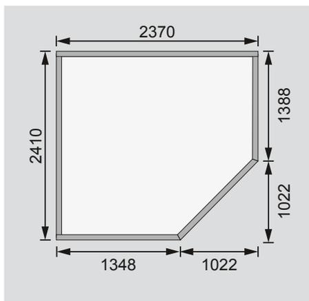
Fundamentplan mit Boden (in mm)
