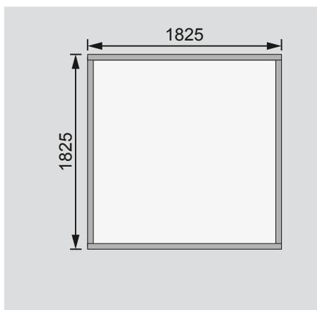
Fundamentplan mit Boden (in mm)
