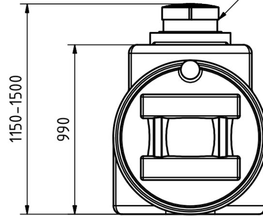
2. Moegliche Fläche zum bohren und anbringen einer Gummilippendichtung DN110 für das Zulaufrohr.
