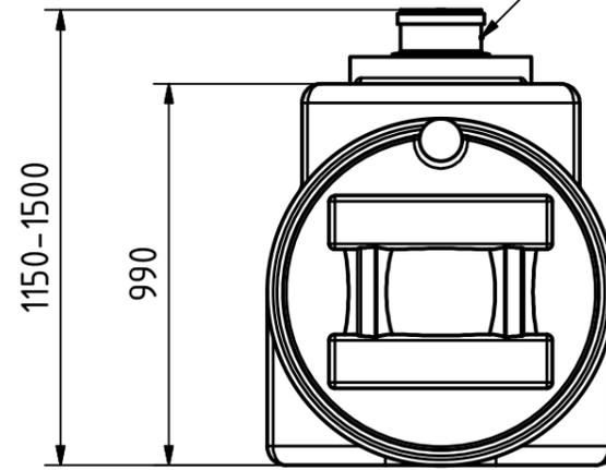
2. Moegliche Fläche zum bohren und anbringen einer Gummilippendichtung DN110 für das Zulaufrohr.
