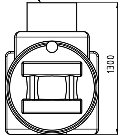
2. Moegliche Fläche zum bohren und anbringen einer Gummilippendichtung DN110 für das Zulaufrohr.
