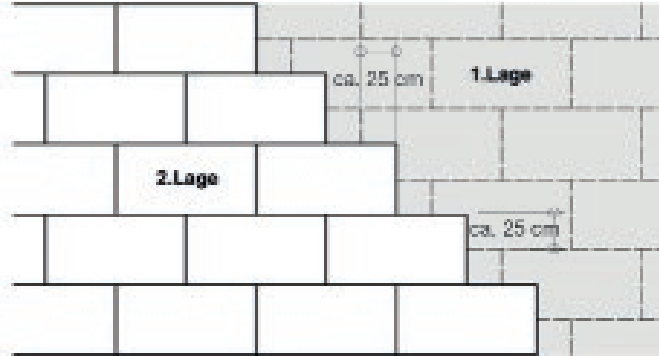
Abb. 28: Zweilagige Verlegung der Dämmplatten
