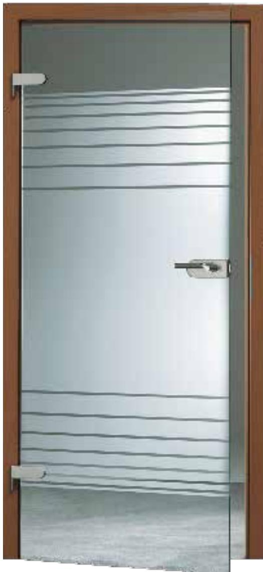
Eine Art der Veredelung von Glasoberflächen ist der Siebdruck. Das Dekor wird bei diesem Verfahren per Farbauftrag über ein Sieb auf die Glasoberfläche gebracht. Bei der Farbe handelt es sich um eingefärbten Glasstaub. Während des Härteprozesses des Glases wird dieser Glasstaub mit einer Temperatur von ca. 650°C fest mit der Glasoberfläche verbunden. Die Oberfläche ist resistent gegen alle säurefreien handelsüblichen Haushaltsreinigungsmittel. Die Farbe verblasst nicht und ist UV-beständig.
