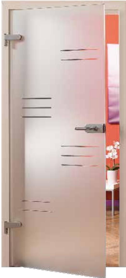
Türen mit Rillenschliff. Hierbei handelt es sich um eine besonders schöne Veredelungsform, bei der in die Oberfläche des Glases eine ca. 6–10 mm Breite V-förmige Rille in matter oder polierter Ausführung eingearbeitet wird. Der Einsatz von CNC-gesteuerten Maschinen lässt Spielraum für individuelle Gestaltungsmöglichkeiten.
