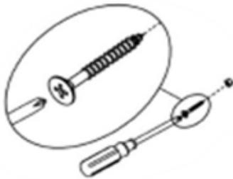
5. Haken Sie das Paneel in die 3 Schrauben ein und schieben sie es nach rechts, bis es sicher eingerastet ist.
