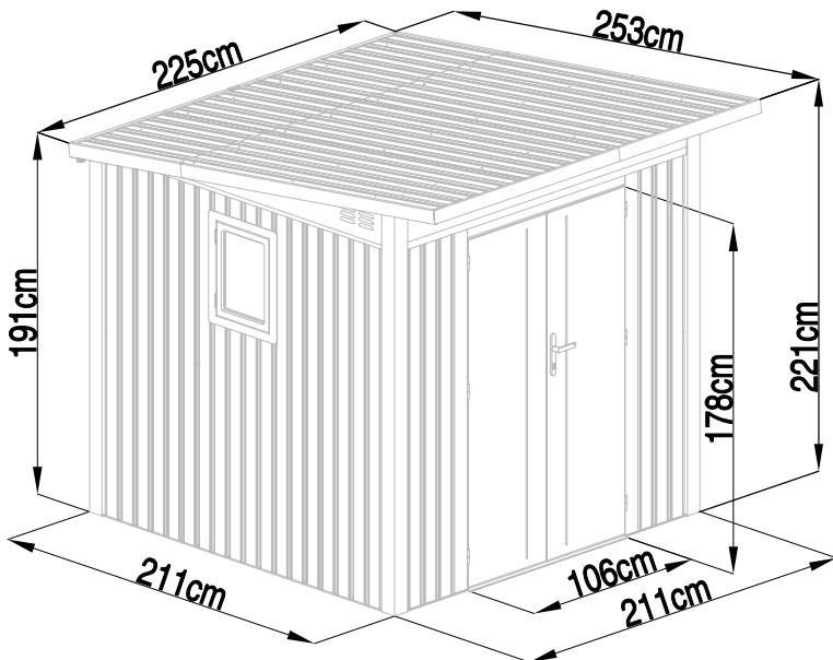
**DE** Erforderliche Fläche für die Aufstellung des Gerätehauses. Sorgen Sie für einen ausreichenden Montage-Freiraum.
