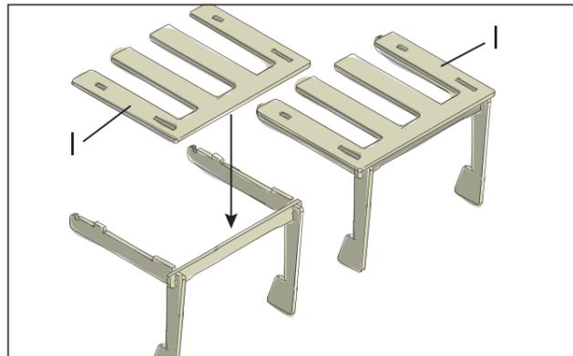
Stecke auf die beiden vormontierten Unterteile jeweils eine Finger-Abdeckplatte (I). Zum besseren Verbinden können die Elemente um 180° gedreht werden.
