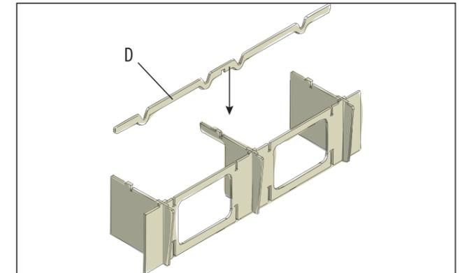
Verbinde die drei Wandelemente so mit der Strebe (D), dass die Strebe auf beiden Seiten übersteht. An der Oberkante muss die Strebe bündig mit den Wandelementen abschliessen.
