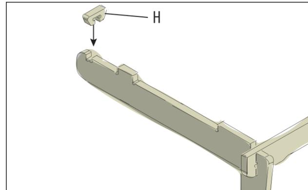
Stecke am Ende der Winkelemente jeweils einen Stopper (H) in die vorgesehene Aussparung. Er sorgt dafür, dass die Ausziehelemente nicht aus dem Gehäuse herausfallen.
