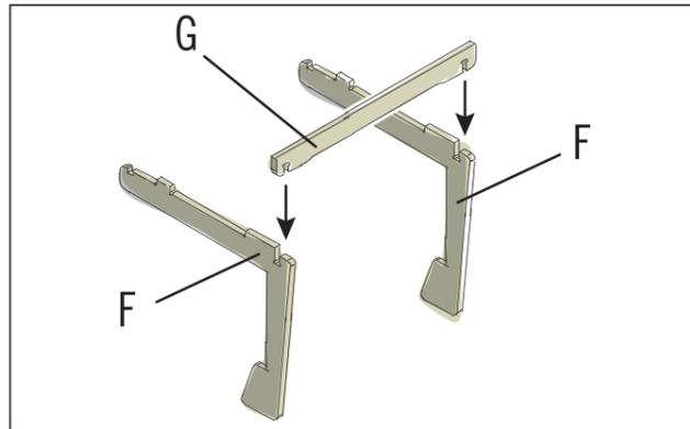
Das Ausziehelement wird zwei mal benötigt. Beide Elemente sind identisch. Verbinde die beiden Winkelemente (F) oben mit der Strebe (G).
