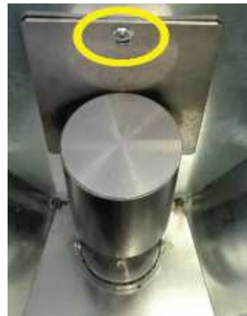
Fig. 33 - Entfernen der Schraube
