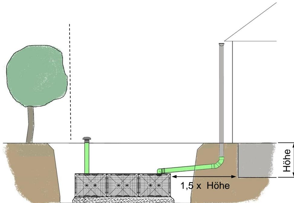
Die Versickerungsanlage sollte grundsätzlich in der Nähe des Regenwasseranschlusses geplant und angelegt werden.
