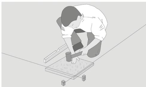
Die erste Platte sollte in Mörtel verlegt werden, damit die Platte beim Fluchten nicht verrutscht.
