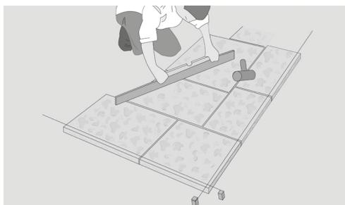
Verfügen Sie die Platten mit einem geeigneten Fugenmaterial. Vermeiden Sie eine Verschmutzung der Oberfläche.
