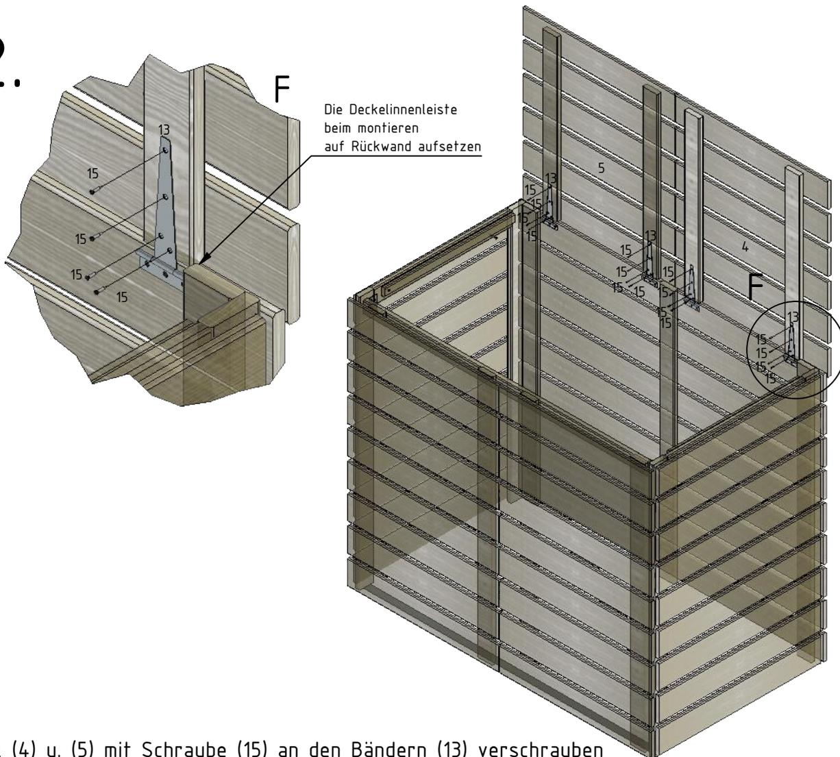
Deckel (4) u. (5) mit Schraube (15) an den Bändern (13) verschrauben
