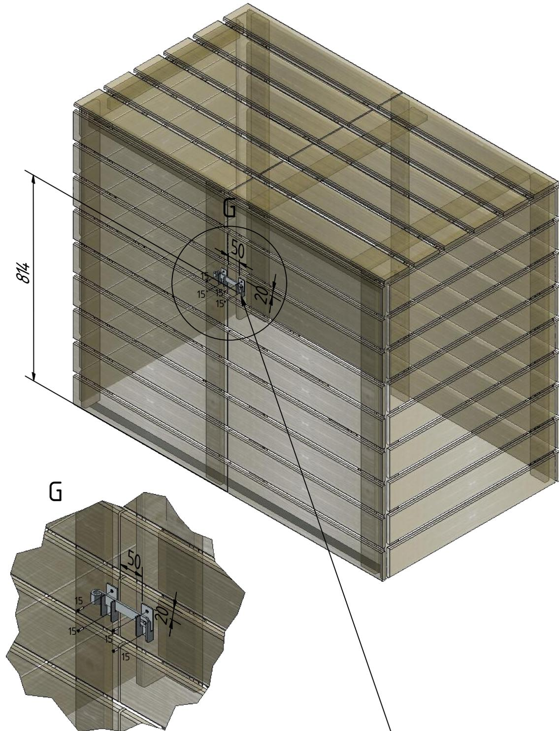
Schlagladenüberwurf (11) mit Schraube (15) montieren
