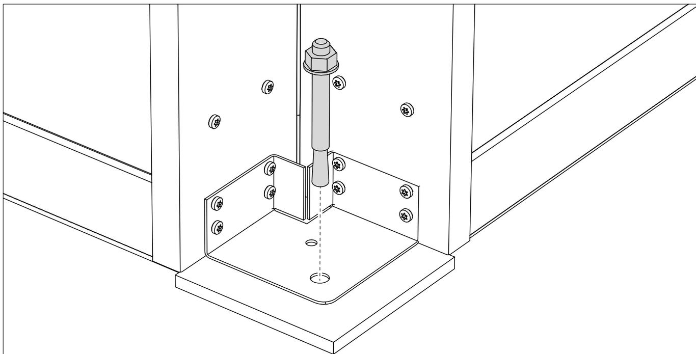
Exemple donné pour un sous-sol en béton. Fixer l'abri de jardin dans les règles de l'art.
