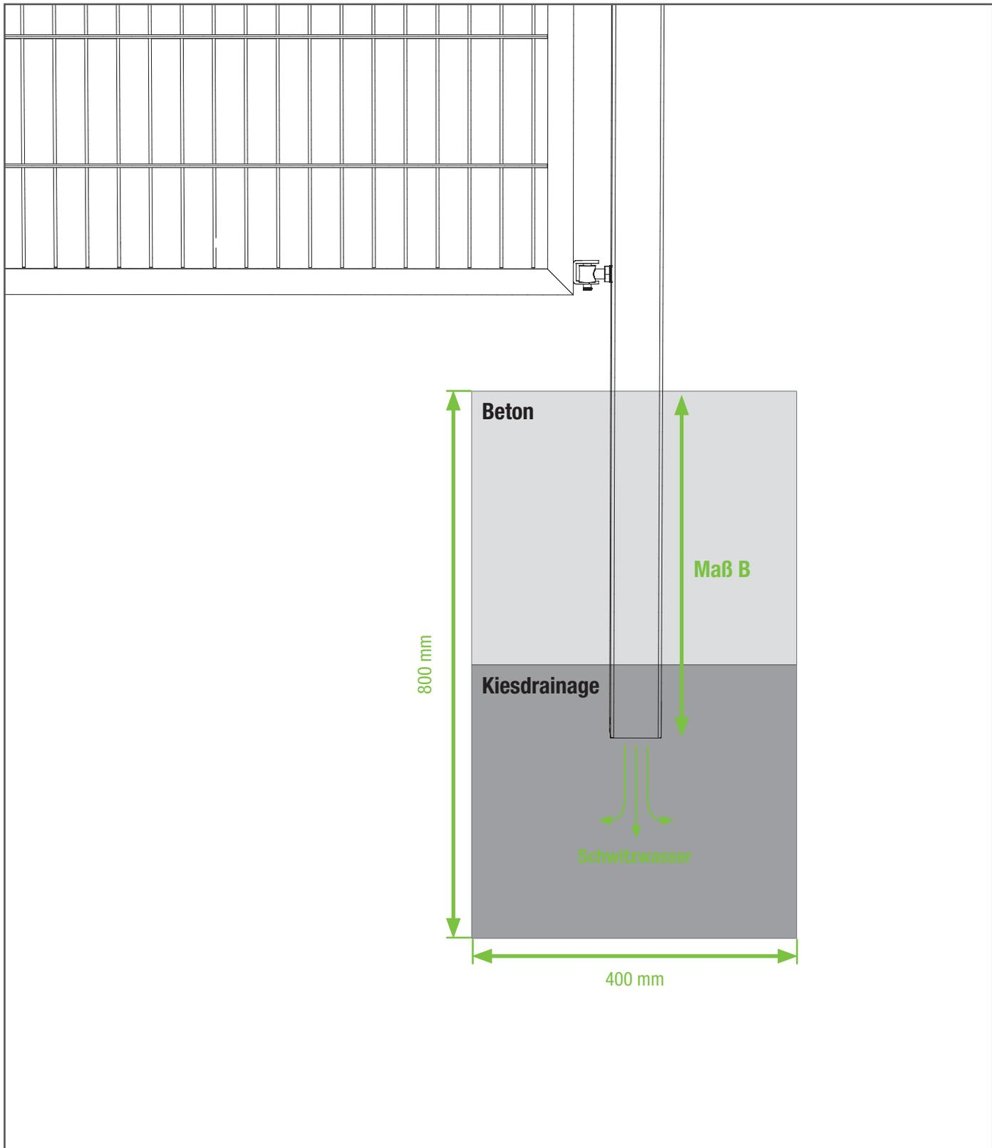
Im unteren Teil des Fundamentloches Kies zur Drainage einfüllen.
