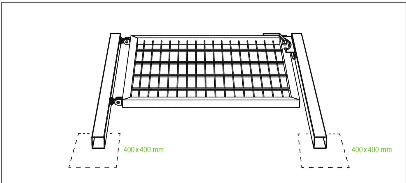
Tor komplett montiert flach auf den Boden legen, um die Position der auszuhebenden Löcher zu ermitteln.
