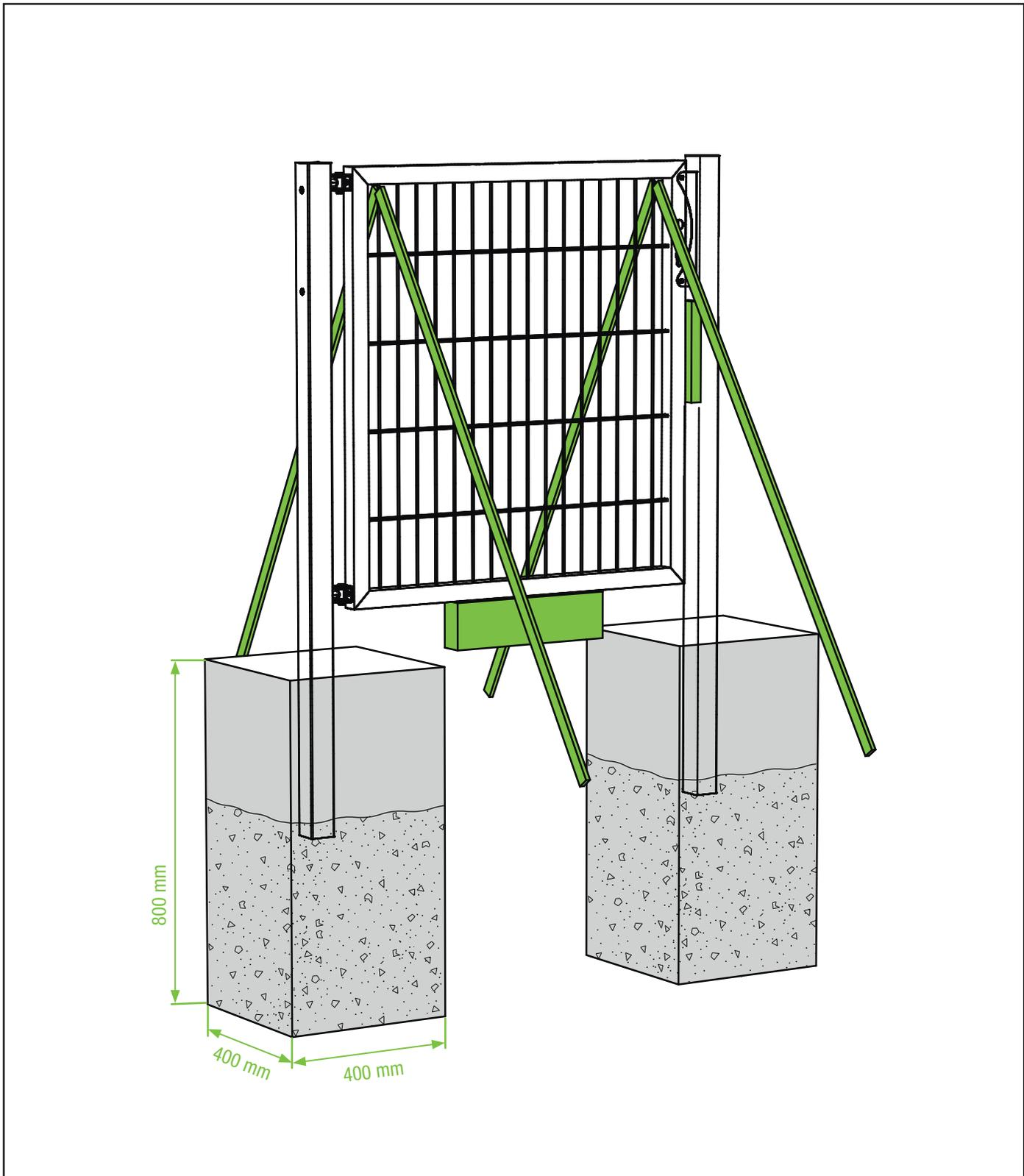
Das Tor vor dem Betonieren mit Dachlatten abstreben und die Abstände von Tor zu Boden mit passenden Holzstücken justieren. Eine schmalere Latte unterhalb des Torschlusses (zwischen Torflügel und Pfosten) stellt den korrekten Abstand zum Schließen sicher.
