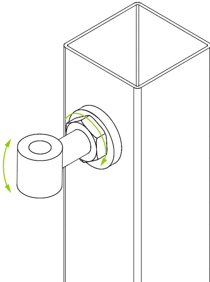
Kontering mit Mutter fixieren und den Kloben vertikal ausrichten (ggf. Mutter etwas lösen, um den Kloben besser bewegen zu können).
