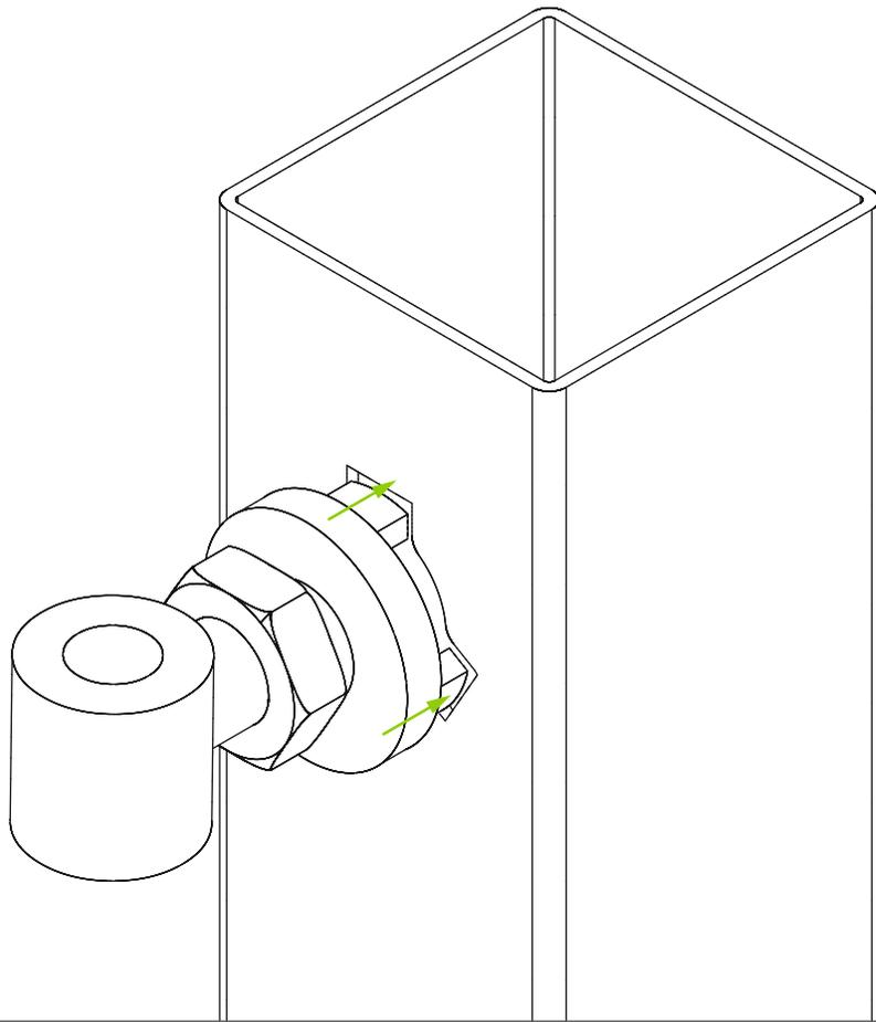
Kontering zur Sicherung gegen Verdrehen in das Loch einschieben.
