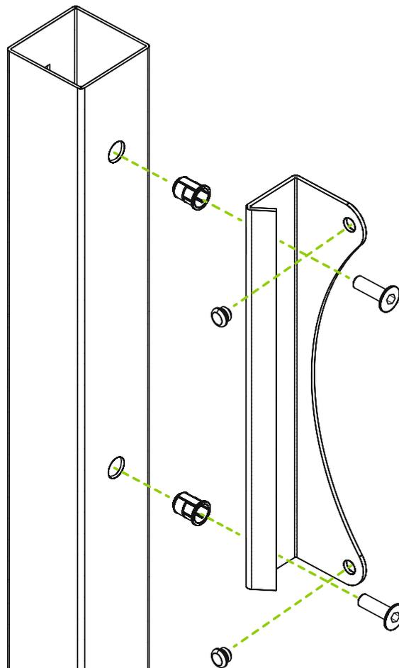
Käfigmuttern einsetzen, Anschlag anschrauben, anschließend Anschlagstopfen eindrücken.
