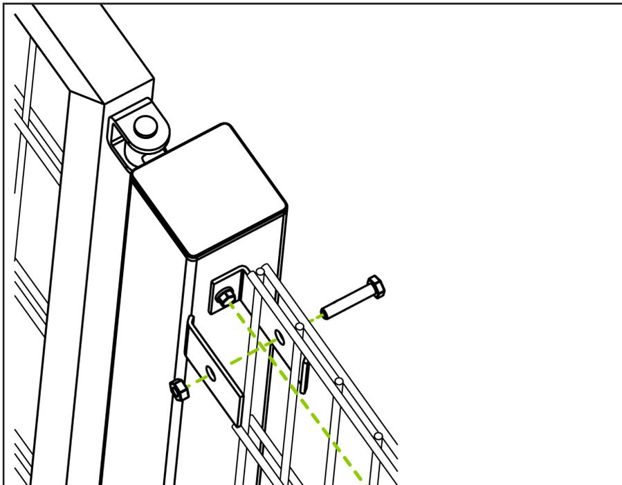
Bei Bedarf Mattenanschlußwinkel mit Bohrschraube im Pfosten verankern und Matte zwischen den beiden Laschen festklemmen.
