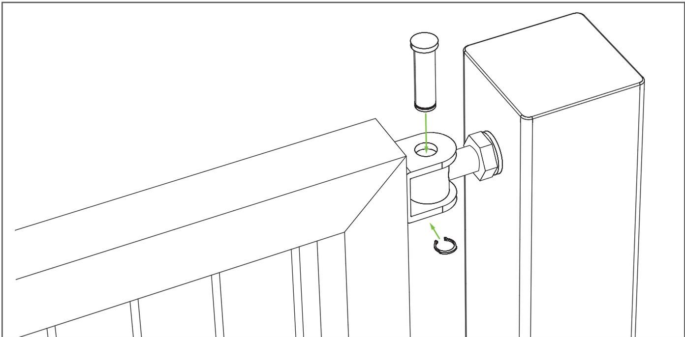
Tor einhängen und mit Bolzen sowie Sprengring fixieren.
