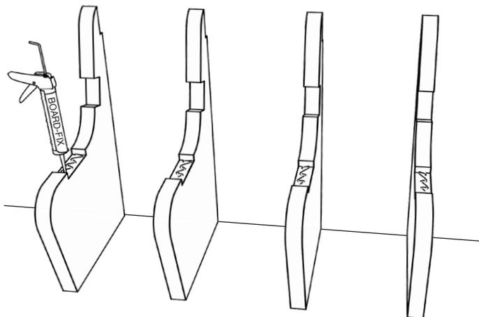
3) Im ausgesparten Bereich für die Strebe C1 wird BOARD-FIX® aufgetragen.
