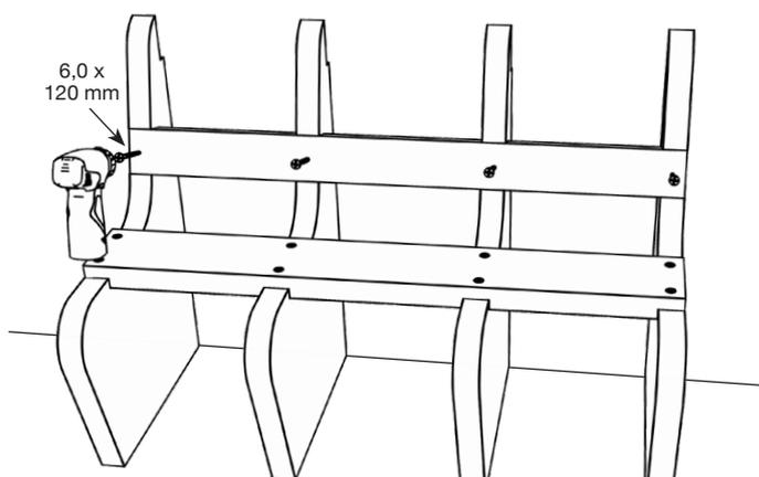
6) Die Strebe C2 wird angeklebt. Die Stützwände A werden im gleichen Abstand ausgerichtet und angeschraubt.
