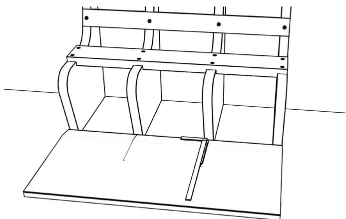
9) Die Abdeckung B1 wird angelegt und die Positionen der mittleren Stützwände angezeichnet.
