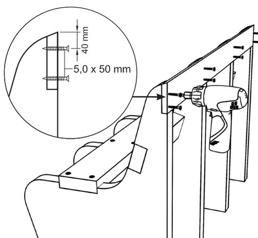
8) Die Strebe C3 wird angeklebt und angeschraubt.
