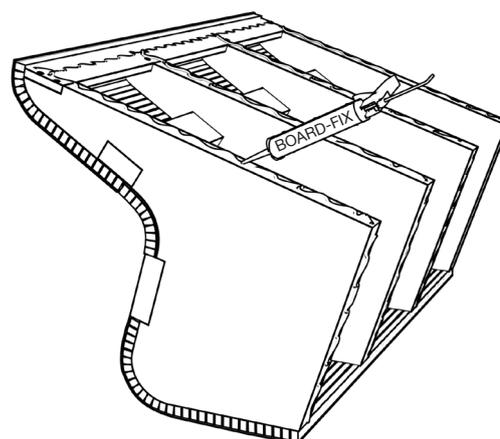
22) Die Sitzbank muss an der Wand und am Boden angeklebt werden. Hierzu wird BOARD-FIX® auf die Stirnflächen der Rückseite und Unterseite aufgetragen.
