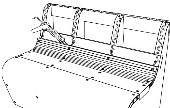
19) Auf den Stützwänden A, der Strebe C1 und der Abdeckung B2 wird BOARD-FIX® aufgetragen.
