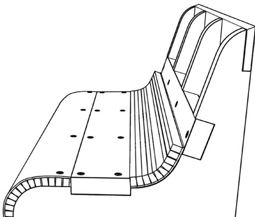
15) Die Abdeckung B2 sollte vor dem Ankleben vorgebo-gen werden, um die Eigenspannung herauszunehmen. Anschließend wird die Abdeckung B2 mit der geschlitzten Seite nach oben angeklebt.
