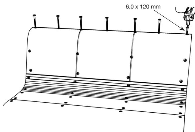
21) Die Abdeckung B3 wird angeklebt und von unten nach oben angeschraubt.
