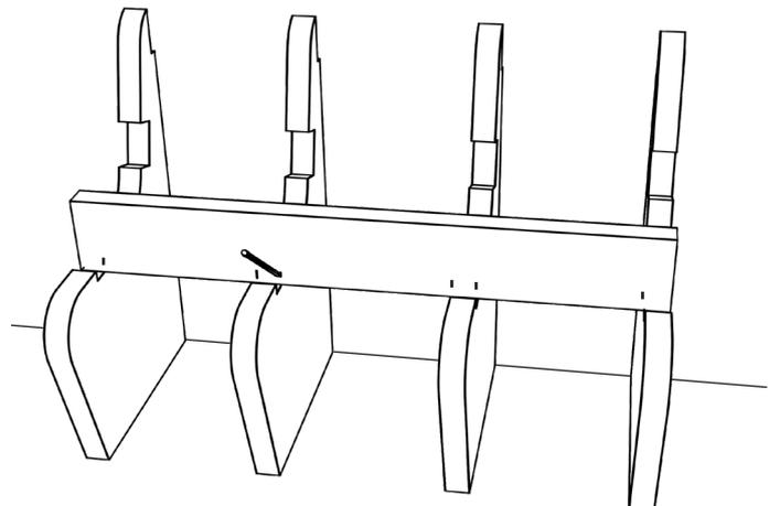
2) Auf der Strebe C1 werden die Positionen der Stützwände A angezeichnet.
