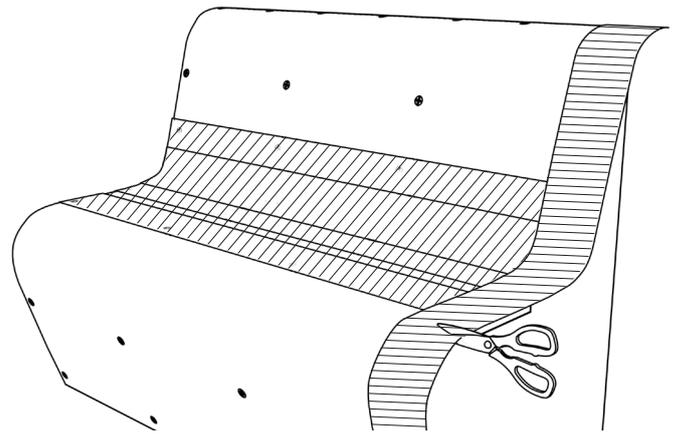
24) Die Abdeckung B2 sowie alle Stoßfugen und sichtbaren Stirnkanten werden mit dem selbstklebenden JACKOBOARD® Armierband abgeklebt.
