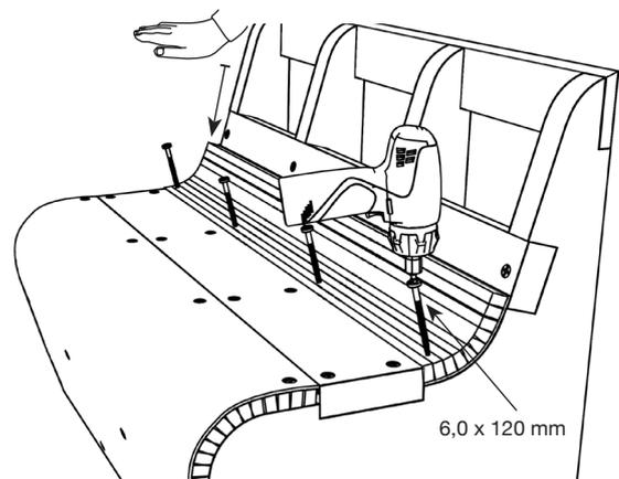
16) Die Abdeckung B2 wird von oben angedrückt und angeschraubt. Zuerst die untere Reihe anschrauben ...
