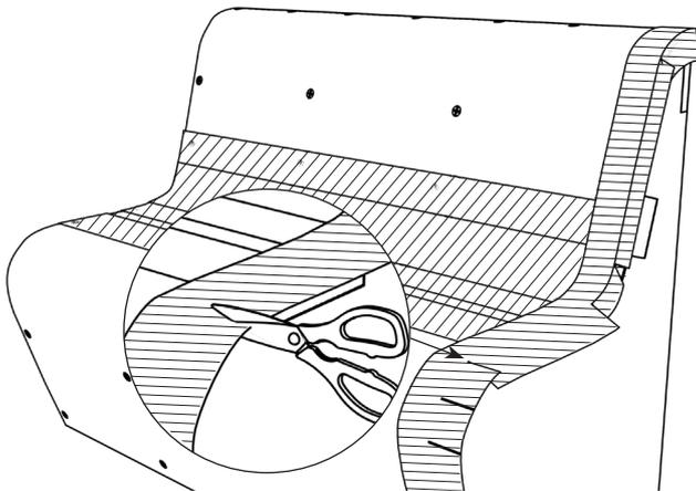
25) Bei den Rundungen wird das Armierband mit der Schere eingeschnitten und überlappend angeklebt.
