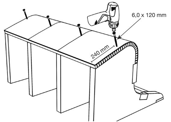
12) Die Sitzbank wird auf den Rücken gelegt. Die Abdeckung B1 wird fest um die Rundung geführt, ange-drückt und angeschraubt.
