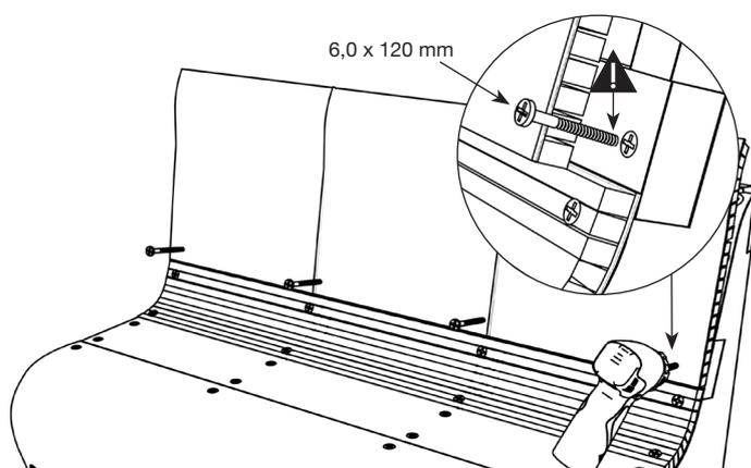
20) Die Abdeckung B3 wird angeklebt und von unten nach oben angeschraubt.
