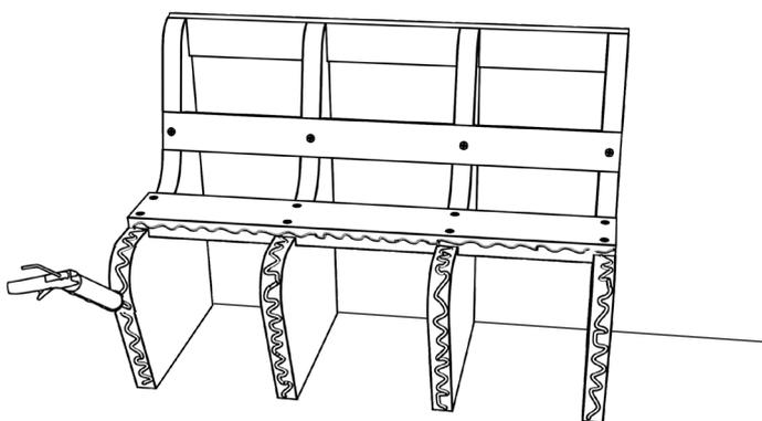
10) Auf den Stützwänden A und auf der Längsseite der Strebe C1 wird BOARD-FIX® aufgetragen.
