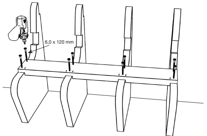
4) Die Strebe C1 wird angeklebt. Die Stützwände A werden an den Markierungen ausgerichtet und angeschraubt.
