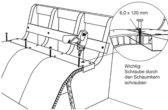
11) Die Abdeckung B1 wird aufgeklebt und im oberen Bereich angeschraubt.
