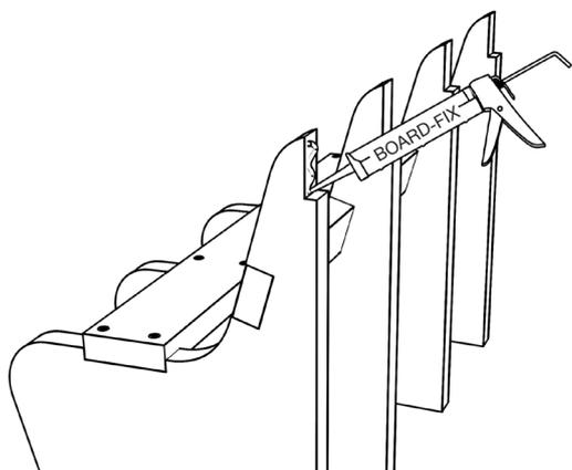
7) Im ausgesparten Bereich für die Strebe C3 wird BOARD-FIX® aufgetragen.
