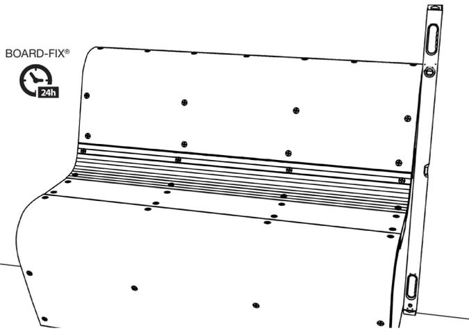
23) Die Sitzbank wird an der Wand und am Boden angeklebt, so dass sie lotrecht positioniert ist.
