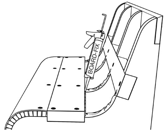
14) Auf den Stützwänden A und der Längsseite der Strebe C1 wird BOARD-FIX® aufgetragen.
