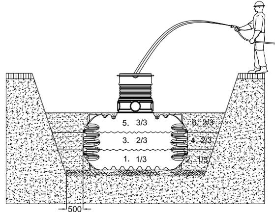
Bei Installation der Behälter unter Flächen die mit **PKW befahren** werden muss eine ca. 200 mm bis 300 mm hohe **Schotter-Tragschicht** über dem Behälter eingebracht werden. Die Fläche der Schotter-Tragschicht sollte der Größe der Sohle der Baugrube entsprechen.
