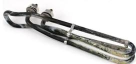
Niedriger pH-Wert und minderwertiges Chlor führen zur Verkalkung des Heizelements
