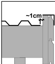
Lassen Sie zwischen Dachplatte und innerer Blende einen Abstand von ca. 1cm. Der entstandene Zwischenraum wird für die Belüftung benötigt.
