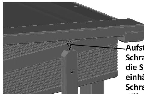
Aufsteller 7 mit Schraubhaken G in die Schrauböse H einhängen und den Schraubhaken G mit Hilfe einer Zange zur Öse biegen!
