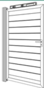
14 | Die waagerechte Ausrichtung des Torelements mit der Wasserwaage kontrollieren, gegebenenfalls korrigieren und mit einer Holzleiste stabilisieren.
