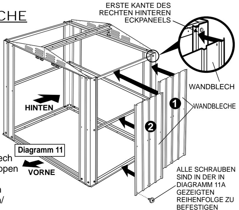
ALLE SCHRAUBEN SIND IN DER IN DIAGRAMM 11A GEZEIGTEN REIHENFOLGE ZU BEFESTIGEN
