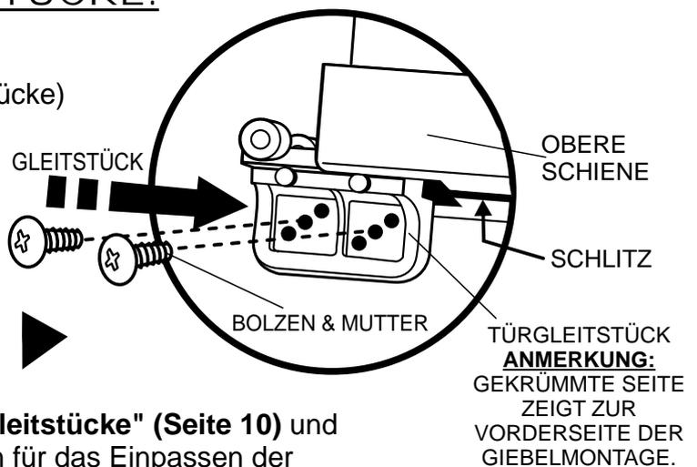
Beachten Sie den **Vormontageabschnitt "Türgleitstücke" (Seite 10)** und den Schritten **27-29** können Sie alle Einzelheiten für das Einpassen der Türgleitstücke und das Justieren der Türen entnehmen.
