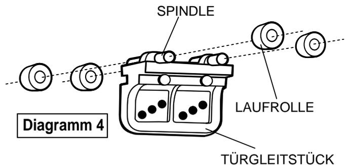
**Anmerkung:** Die Türgleitstücke MÜSSEN mit der GEKRÜMMTEN Seite zur VORDERSEITE der Giebelmontage, wie gezeigt, positioniert werden. Siehe Diagramm 5.
