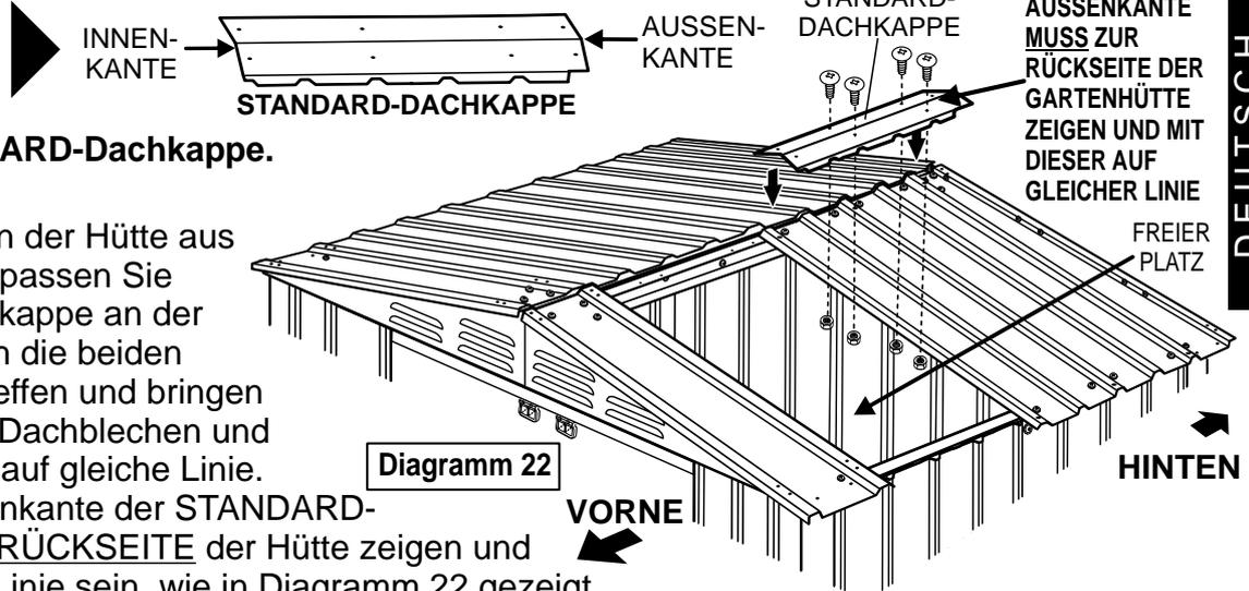
Arbeiten Sie vom Innern der Hütte aus durch den freien Platz, passen Sie eine STANDARD-Dachkappe an der Position ein, an der sich die beiden hinteren Dachbleche treffen und bringen Sie die Löcher mit den Dachblechen und dem Dachstartelement auf gleiche Linie.
