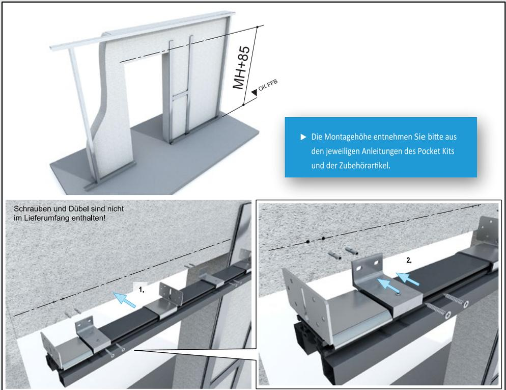
6 Schiene seitlich ausrichten und fixieren.
