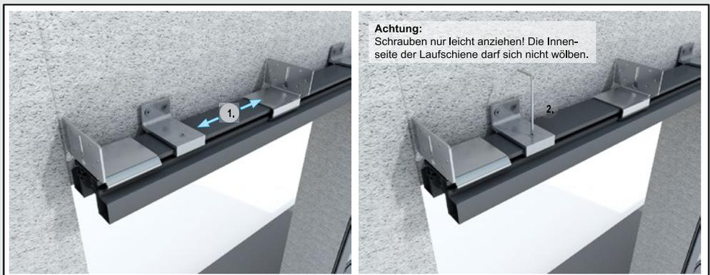
7 CW-Profile einsetzen und an Laufschiene schrauben
