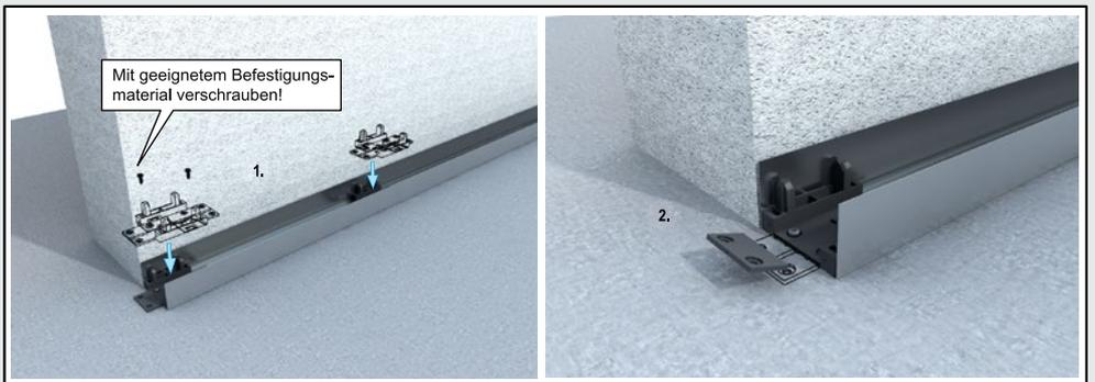
3 Taschenprofil an der Wandseite auf die Standfüße pressen und mit der Wand verschrauben.
