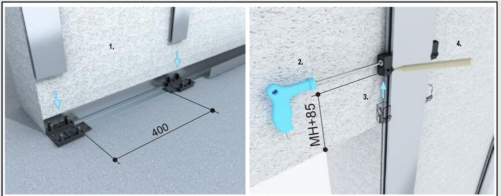
3 Taschenprofil an der Wandseite auf die Standfüße pressen und mit der Wand verschrauben.
