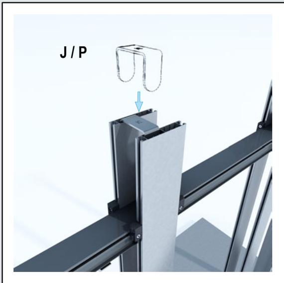
10 Bodenführung montieren
